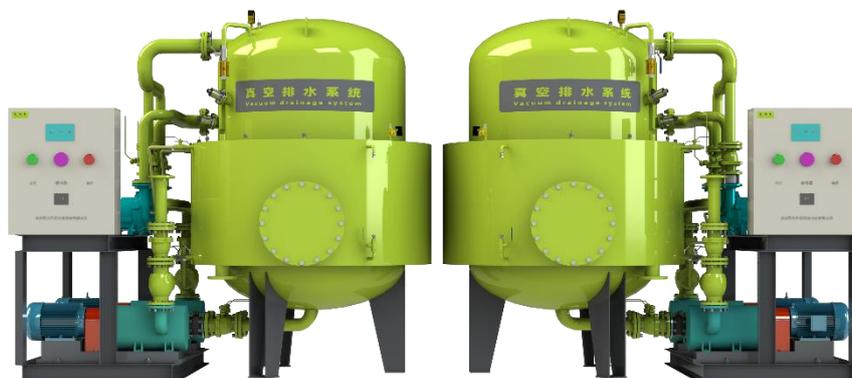
真空泵站包含一个控制器、一套液位传感器、至少两个真空泵(配套气水分离器)、至少两个排污泵、至少一个真空废污水罐等。整个泵站除尾气处理装置排放口与大气(或除臭设备)相通外,完全处于密闭状态,避免了臭气外溢。真空泵站使管路内始终维持真空,因此排水管路可实现向上提升,提升高度高达 4.5 米左右,完全打破了水往下流的设计理念。
